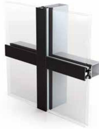
Ridotto ingombro dei profili per ottenere la massima trasparenza: con il profilo pressore integrato, WICTEC 50 offre una soluzione economica con aspetto simile alla facciata strutturale. Il metodo costruttivo con un pressore basso o complanare è semplice e veloce come per un classico sistema di facciata continua a montanti e traversi.
