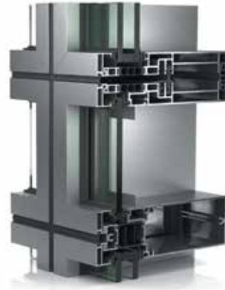
WICTEC EL60 è la versione più sottile tra le facciate ad elementi, con sezione in vista di soli 60 mm sia dentro che fuori. I fermavetro esterni con taglio a 45° donano un aspetto particolarmente elegante a cornice. Come risultato di un isolamento termico estremamente ottimizzato, questo sistema primeggia nella sua categoria con straordinari valori di  $U_{cw}$  fino a 0,9 W/(m<sup>2</sup>K).
